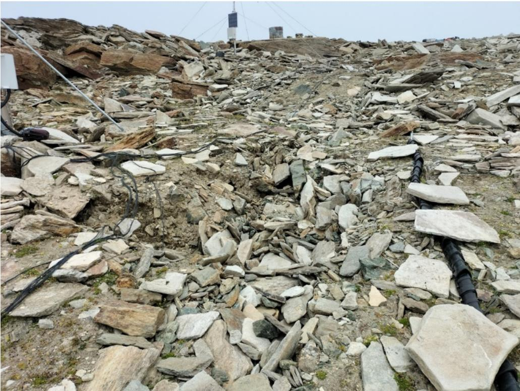
*Affaissements du sol vraisemblablement causés par la perte de glace dans le sol ou par des mouvements croissants dans les environs de la station de mesure du pergélisol au Stockhorn au-dessus de Zermatt à environ 3400 m d'altitude (photo: C. Pellet).*
